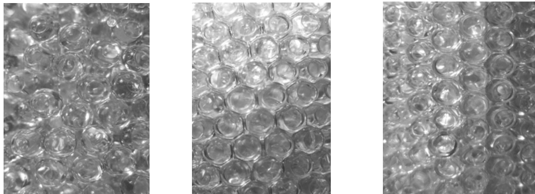
Рис. 2 – Структура средней части сыпучего слоя до (левый снимок) и после (снимки в центре и справа) вибровоздействия
